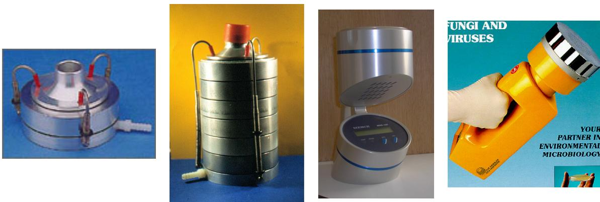
Figure 7 : Exemples d'impacteurs en milieu solide : l'Andersen à 1 et 6 étage(s), le MAS-100, le SAS.
