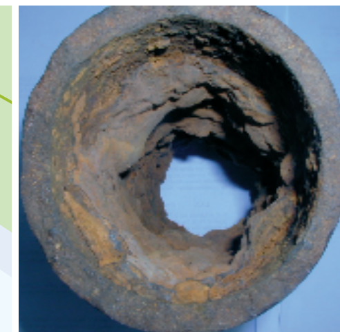
Vue interne d'une canalisation avec corrosion
