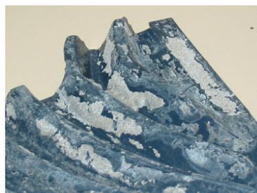
Figure 1K : Exemples de corps d'échange encrassés
